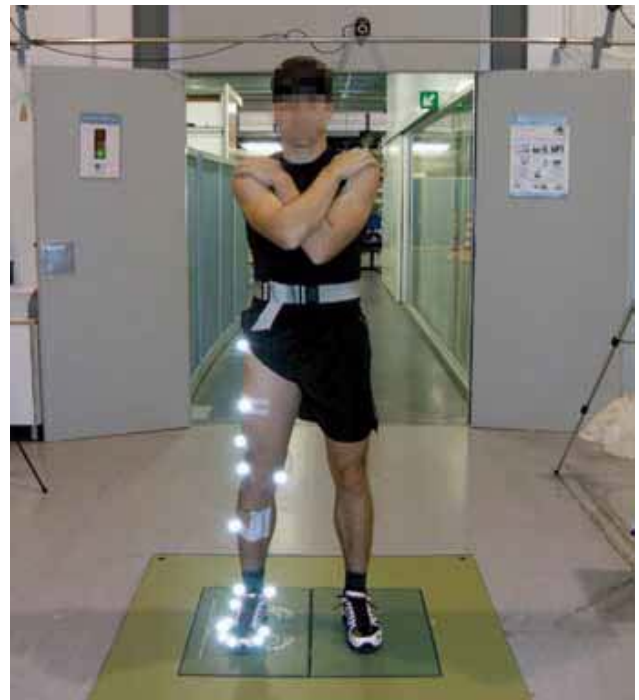
Figura 4. Corredor instrumentado durante o processo de calibração.
