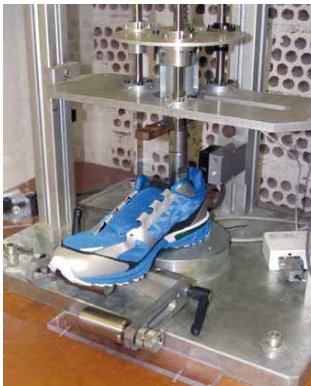
Figura 7. Ensaio de absorção de impacto com a máquina LecCus/IBV®
