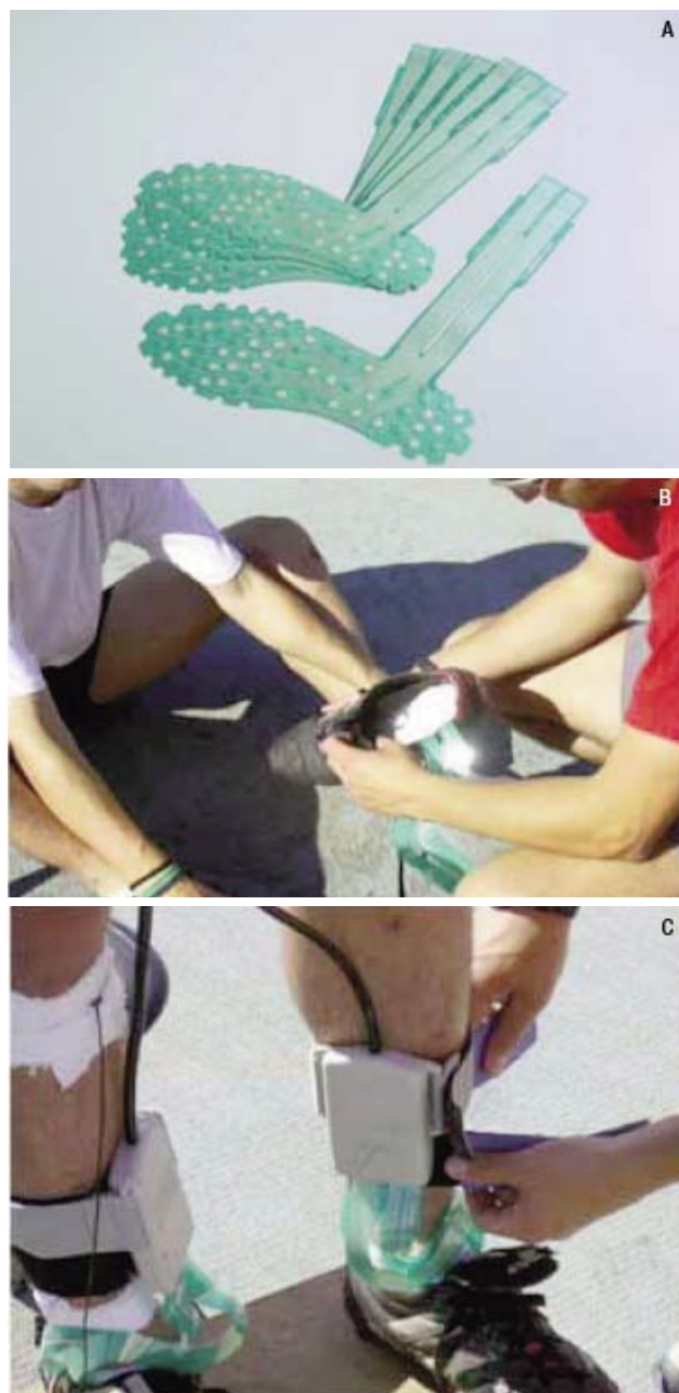
Figura 4. (A) Palmilhas instrumentadas; (B) Detalhe da colocação da palmilha no calçado; (C) Detalhe da fixação da equipe de medida (medição) ao tornozelo.
