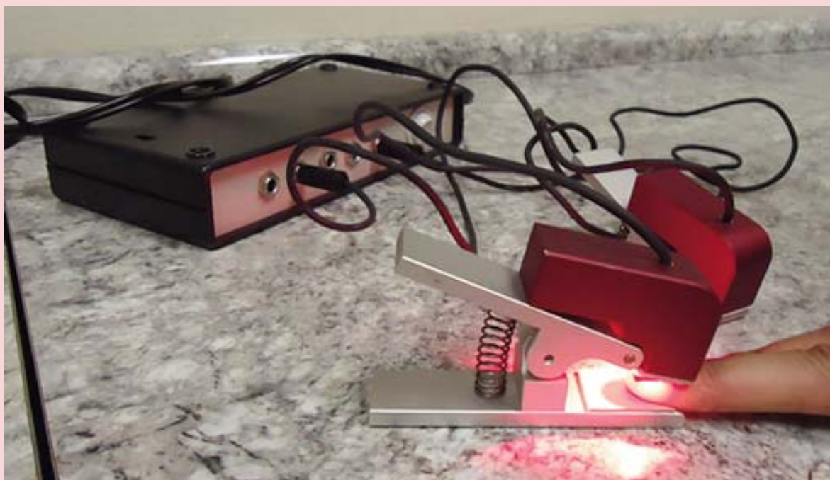
Protótipo em funcionamento: a luz activa substâncias específicas da medicação aplicada na unha doente, gerando uma reação química que libera espécies de oxigênio que são prejudiciais aos fungos causadores da onicomicose.
