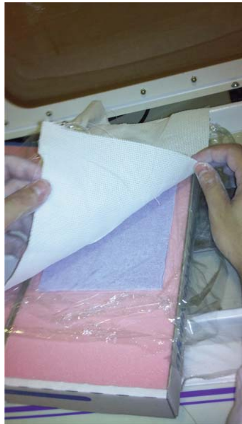
Fig 4 - Resina envolta entre plásticos. Colocação de algodão para proteção.
