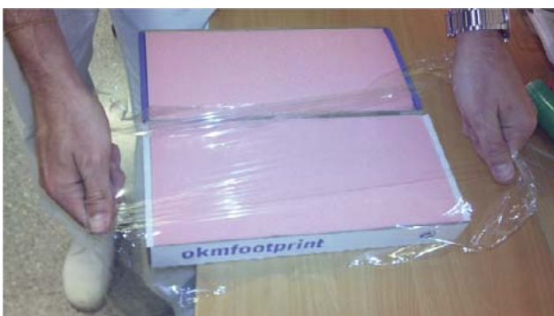
Fig 3 - Colocação do filme sobre a espuma.
